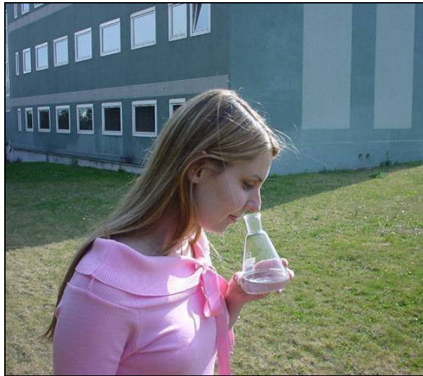
Photographie 1 : Mesure d'intensité olfactive dans l'environnement selon le protocole de la norme AFNOR NF X 43-103
